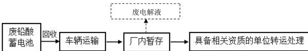
图 2-5 废蓄电池回收暂存工艺流程
