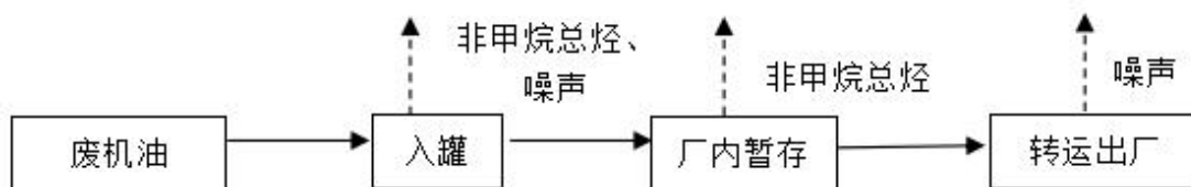
图 2-4 废机油回收暂存工艺流程
