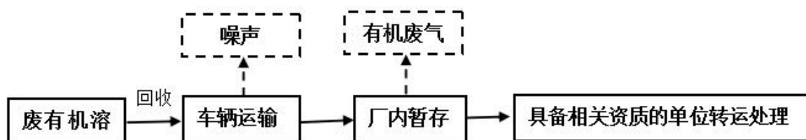
图 2-6 废有机溶剂回收暂存工艺流程
